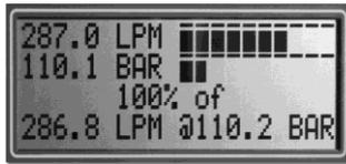
在效率模式下，随着流量和压力的变化，第 3 行上的百分比值变化，表示与起点的差异：
