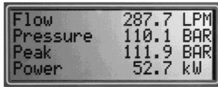
该屏幕以数字格式显示测量类型，数值和工程单位。 底线显示功率或温度取决于选择。
