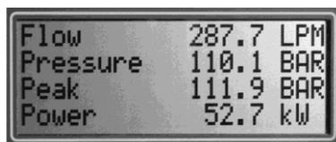
随着压力变化，实际值和峰值在显示屏上更新。峰值压力以 1ms 的典型速率捕获，允许显示快速过渡尖峰，否则错过。
