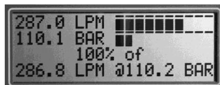
此屏幕用于测试泵容积效率。屏幕最初在屏幕 2 上显示流水线 and 压力，如屏幕 2 所示。一旦捕获到效率参考点，则第三行显示当前效率，底行显示参考点，最上面两行将继续显示当前流量和压力。
