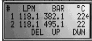
该屏幕显示了一个捕获数据点的表格，可以通过底线上指定的“软菜单”键进行导航。
