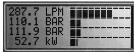
此屏幕以与屏幕 1 相同的顺序显示测量结果，但是这次显示值，工程单位和与所示值相对应的条形图。 条形图从零到测试仪的最大值（见下文）。 底线显示功率或温度取决于选择。
